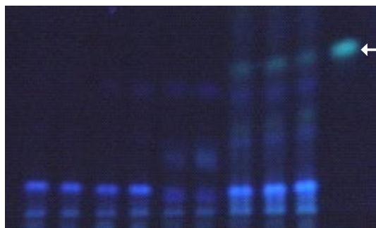
図2 薄層クロマトグラフィーによるラミン材の判別 サクラネチンの検出によってラミンであることが特定できる。 1-6: 類似の樹種 7-9: ラミン( Gonystylus banacanus ) 10: サクラネチン(sakuranetin)標品
