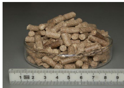
図4 「JES1」を原料とするペレット燃料
