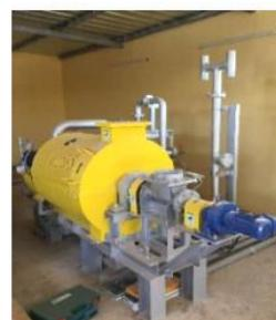
図2 焼成処理に利用する外熱式Uターンキルン (ブルキナファソ、INERA-カンボアンセ支所、)
