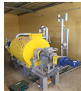
図2 焼成処理に利用する外熱式Uターンキルン (ブルキナファソ、INERA-カンボアンセ支所、)
