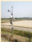
Đặt cảm biến theo dõi mực nước trên đồng ruộng
