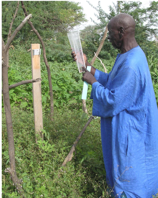
Figure 19 : Méthode de collecte des données pluviométriques.
