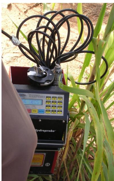
Figure 21. Sonde à neutrons 503 DR Hydroprobe utilisée en 2005
