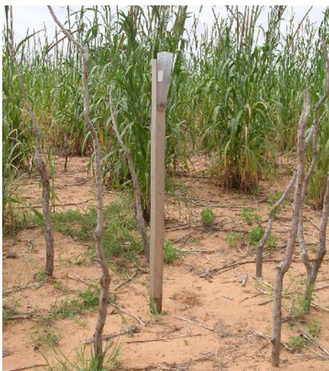
Figure 20. Pluviomètre installé à Bagoua
