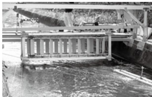
**Fig. 4. A cascade turbine<sup>4</sup>**
