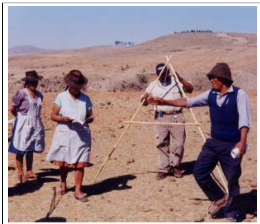
A型水準器の操作方法を学ぶシリチャカ集落の農民
