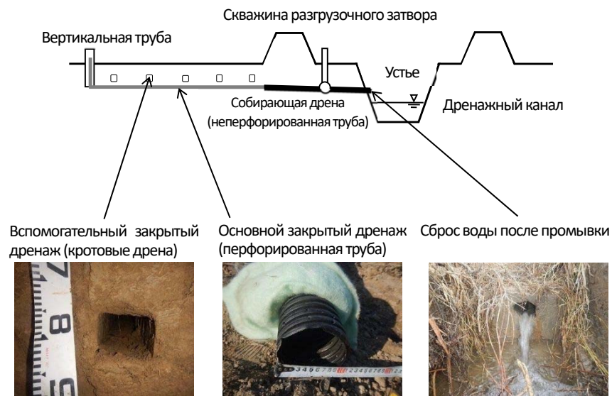
Структура системы мелкого закрытого дренажа
