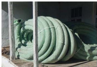
Перфорированная труба с геотекстилем
