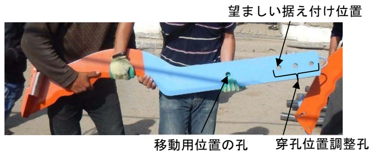
図 4.3.8 穿孔機の切断刃
