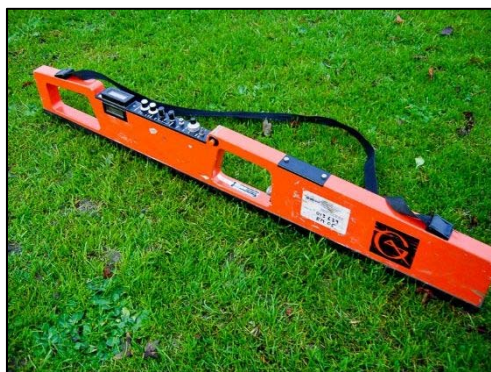
図 3.1.2 電磁誘電法による EC 測定器 (EM38)
