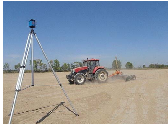
図 2.1.13 レーザー均平化
