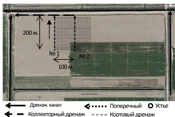
Рис 4.4.1 Схема мелкого закрытого системы дренажа (пример)
