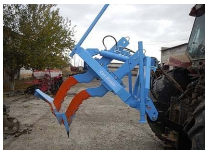
Рис. 4.3.9 Положение ножа во время транспортировки
