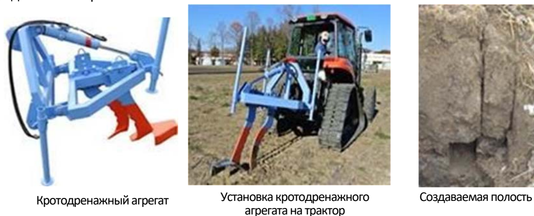
Рис. 4.1.2 Кротодренажный агрегат и нарезанная кротовая дрена
