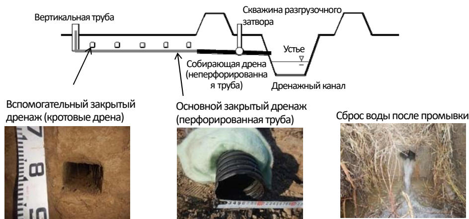
Рис. 4.2.1 Структура системы мелкого закрытого дренажа
