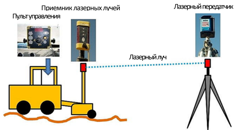
Рис. 2.1.14 Механизм выравнивания лазером
