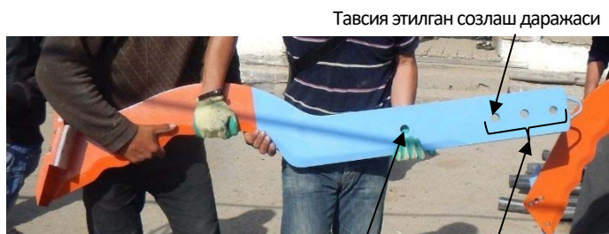
Агрегат йўлда бўлганда пичоқ ерга тегмаслиги учун транспорт ҳолатига ўрнатиш тешиги Ишловчи органининг чуқурлигини созлаш учун тешиклар
