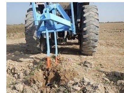
Кўрсичқон дренажи агрегатини кўтарилиб кетиши
