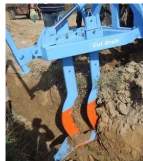
Тупроқни кесиб кўрсичқон дренажини ҳосил қилиш
