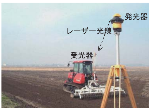
レーザーレベラー
