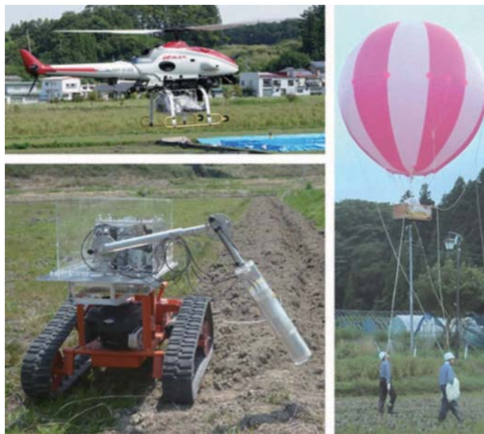
移動体に搭載した測定状況（右：気球、 左上段：無人ヘリ、左下段：ラジコン移動車）
