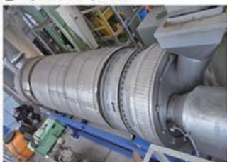
ロータリーキルン乾燥機により20分以内に水分20%以下まで乾燥する
