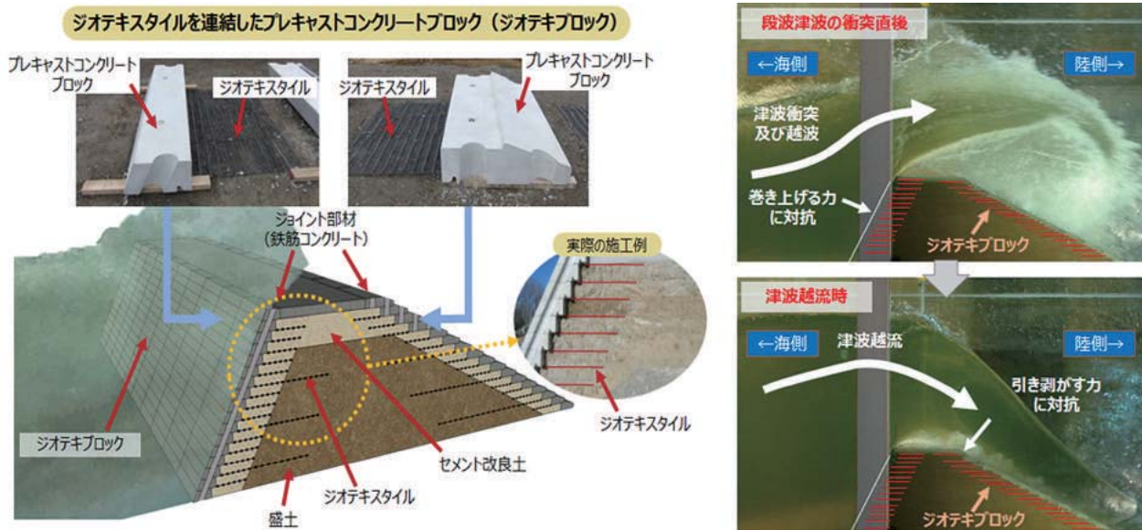
三面一体化堤防の実施イメージ（左図）と巨大津波による水理実験の様子（右図）
