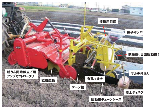
エダマメ用耕うん同時畝立てマルチ直播作業機
