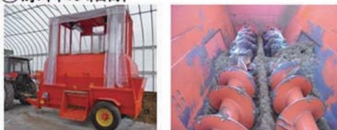
原料を刃付きの攪拌軸により5cm以下に破碎する
