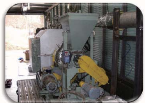
高性能反応促進剤と汚染土壌を混合し 回転式昇華装置へ投入
