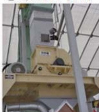
ハンマーミル粉碎機により平均粒径3mm以下に粉碎する
