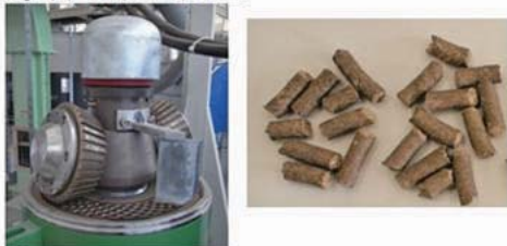
ローラー・ディスクダイ式成型機により直径8mmの円柱状に加工し、水分15%以下まで乾燥し保管
