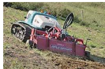
開発したロータリーを無線傾斜地トラクタに装着して耕うんする様子（傾斜20～24°草地）
