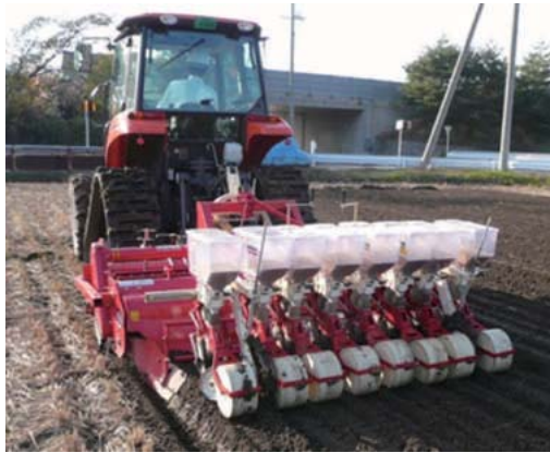
麦の耕うん同時畝立て播種作業機
