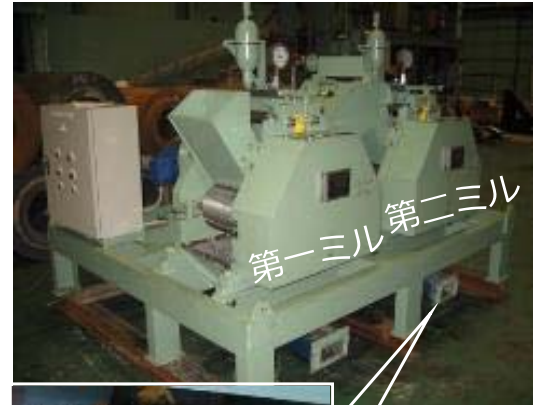
圧搾ミル 処理能力: 745kg/h
