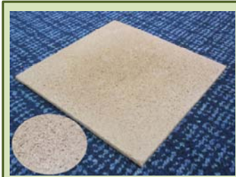
幹粉末を原料としたバインダーレスパーティクルボード(円内は表面の拡大)
