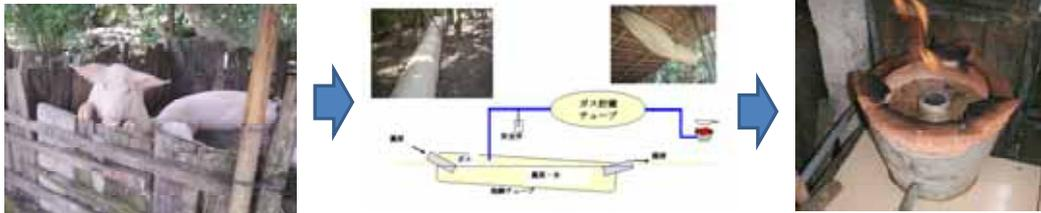
図3. 豚舎(左)からの廃液からバイオガスダイジェスター(中央)でメタンを発生させ、調理(右)に使用し、化石燃料等を削減
